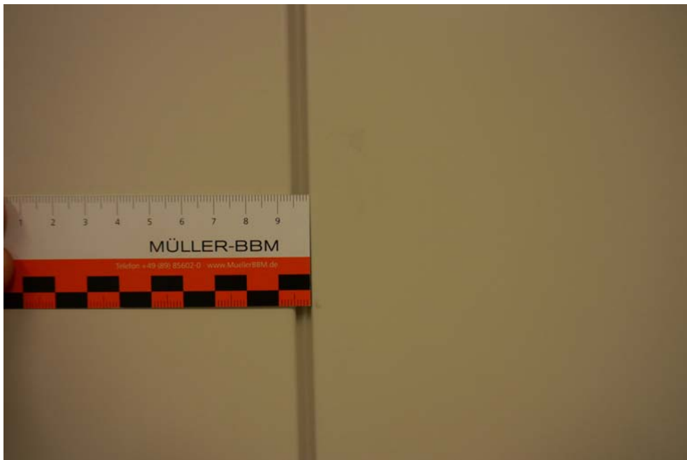
Abbildung B.3. Prüfaufbau im Fensterprüfstand: Detail Stoßfuge zwischen den Einzelementen (im Bild empfangsraumseitig).
