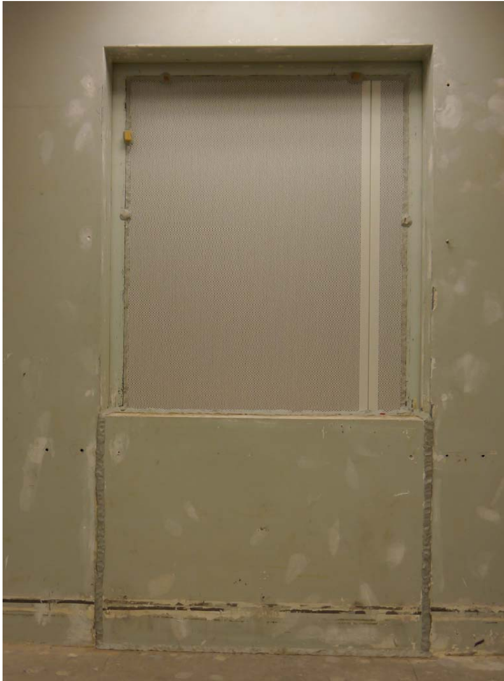
Abbildung B.1. Prüfaufbau im Fensterprüfstand: senderraumseitige Ansicht.
