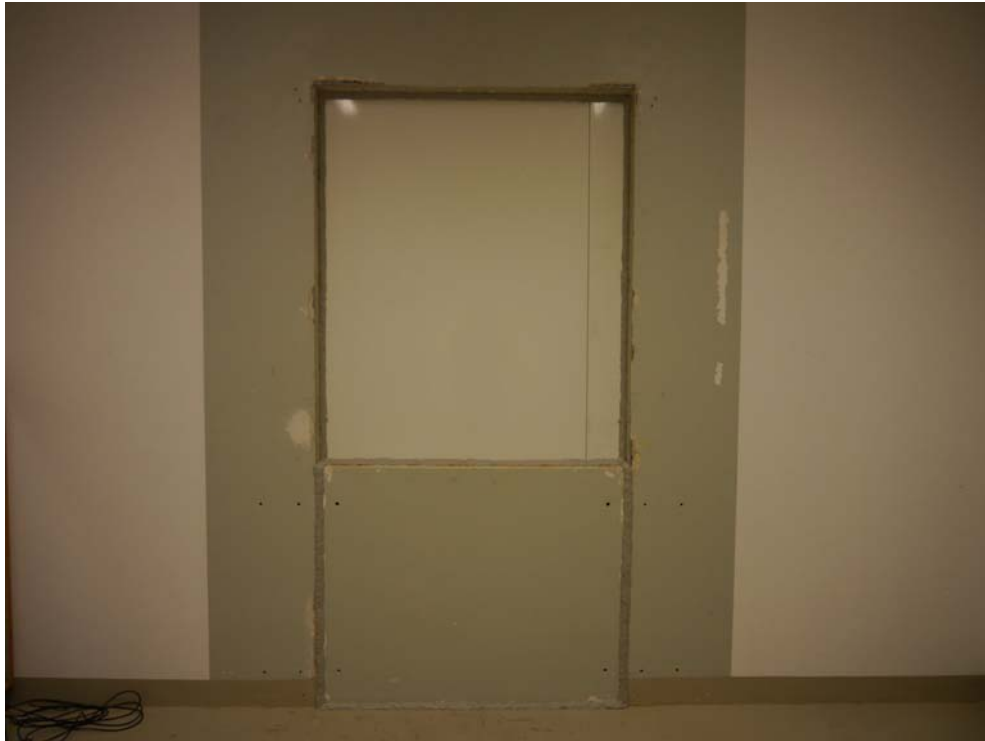
Abbildung B.2. Prüfaufbau im Fensterprüfstand: empfangsraumseitige Ansicht.
