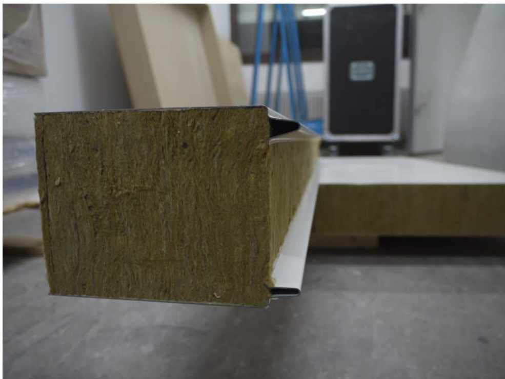
Abbildung B.2 Elementquerschnitt mit Verbindungsprofil (Federseite)
