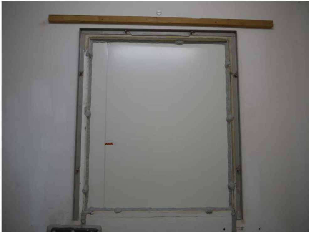
Abbildung B.5 Prüfaufbau empfangsraumseitig
