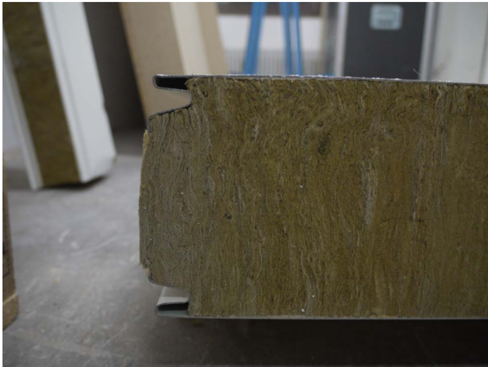
Abbildung B.1 Elementquerschnitt mit Verbindungsprofil (Nutmseite)
